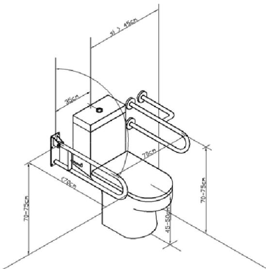
**Funcionamiento:** La posición de uso de la barra abatible es en posición horizontal, siendo la posición abatida sólo recomendada para permitir la accesibilidad.
